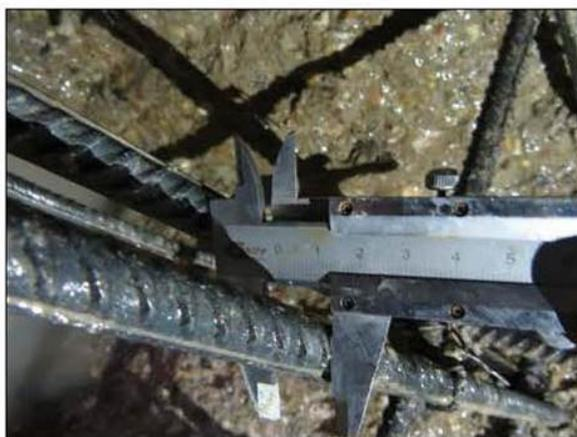
**ФОТО 29. Замер диаметра горизонтального армирования монолитной ж.б. плиты подвала на отм. ниже ±0.000 между осей А/1-А/2 и 1/11-1/14 (зона верхнего армирования)**
