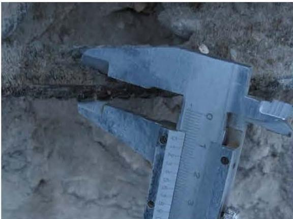
ФОТО 13. Замер диаметра вертикального армирования железобетонной стены на отм. выше ±0.000 между осями 1/8-1/11 и А/4-А/6
