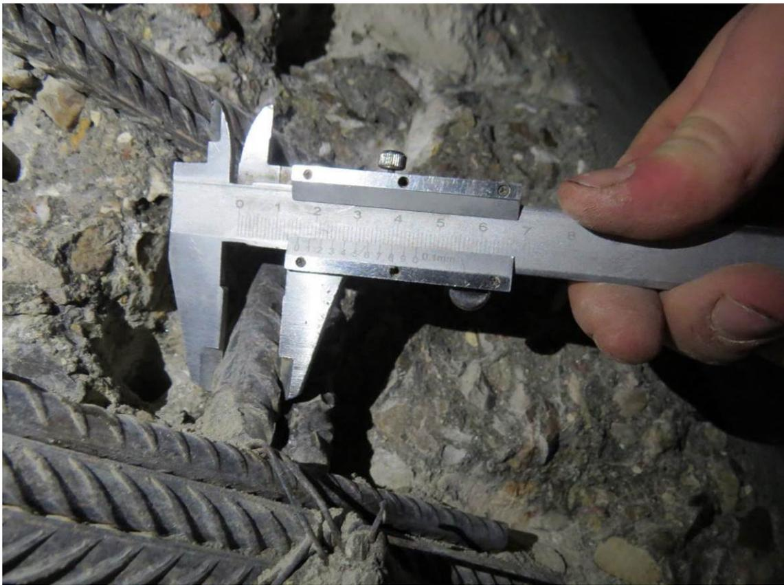
**Рис. 3.2.6. Замер диаметра вертикального армирования пилона ниже отм.  $\pm 0,000$  мм**
