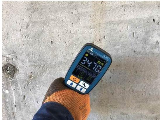
**Рис. 4.3.1. Определение прочности бетона в монолитном пилоне 1-го этажа в/о В/9//1/11-1/14 ультразвуковым методом прибором УК 1401**
