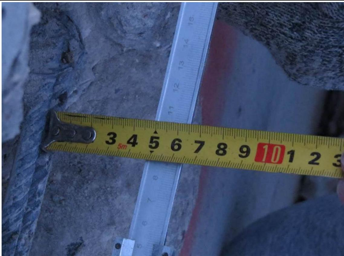
Рис. 3.2.10. Замер толщины защитного слоя бетона пилона выше отм.  $\pm 0,000$  мм
