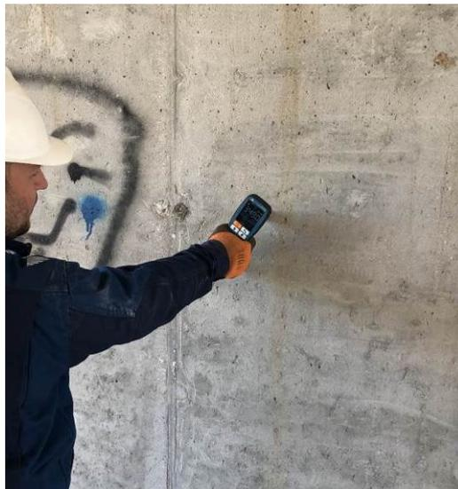
**Рис. 4.3.3. Определение прочности бетона в монолитной стене 1-го этажа в/о Б/4//1/4-1/8 ультразвуковым методом прибором УК 1401**
