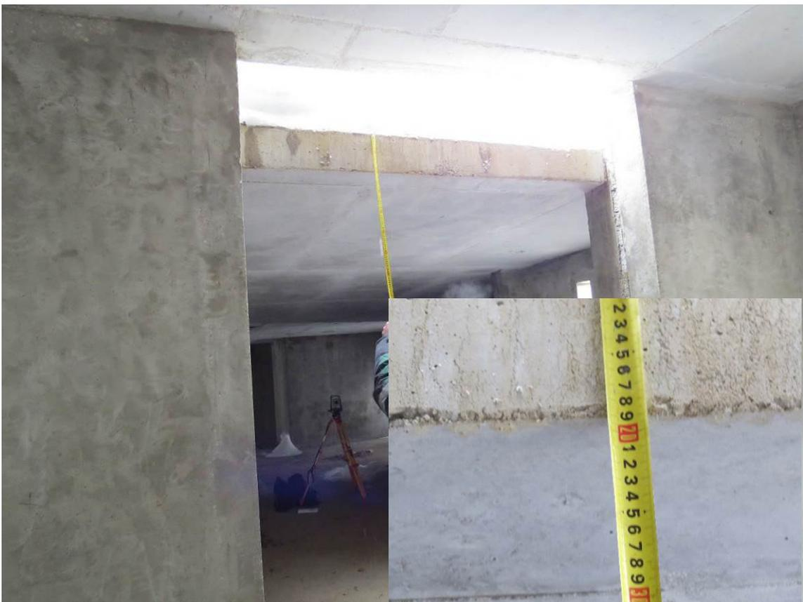
**Рис. 3.3.2. Замер толщины монолитной ж.б. плиты перекрытия подвала**
