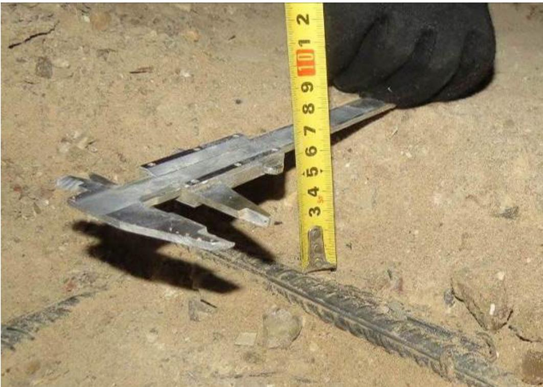
**Рис. 3.3.6. Замер толщины защитного слоя бетона плиты перекрытия подвала по оси Б/5 между осями 1/8-1/11 (зона верхнего армирования)**
