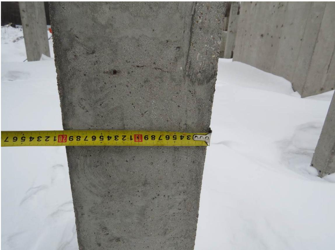
**Рис. 2.1. Замер толщины монолитного ж.б. пилона при помощи металлической рулетки**
