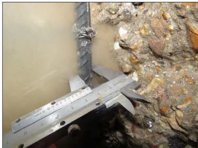
ФОТО 27. Уточнение диаметра арматуры монолитной железобетонной плиты перекрытия подвала на отм. ниже ±0.000 по осям А/1-А/2 между осей 1/11-1/14 (зона нижнего армирования)
