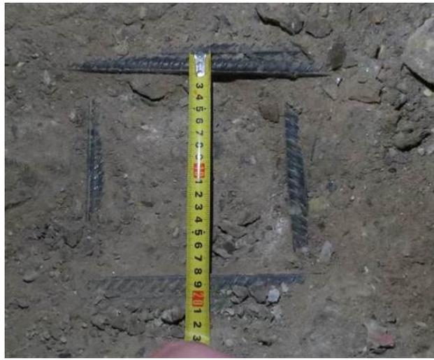
**Рис. 3.1.7. Замер шага вдоль буквенных осей верхней зоны армирования фундаментной плиты на участке вскрытия в секции 2 по оси Б/5 между осями 1/8-1/11**
