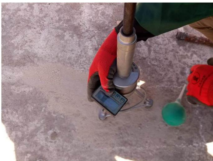
**Рис. 4.2.7. Испытание бетона монолитной плиты перекрытия подвала методом отрыва со скалыванием прибором ПОС 50МГ-4**
